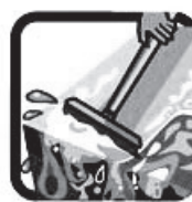
NÃO DEIXE ÁGUA ACUMULADA SOBRE A LAJE
