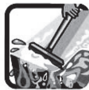
NÃO DEIXE ÁGUA ACUMULADA SOBRE A LAJE
