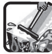
NÃO DEIXE ÁGUA ACUMULADA SOBRE A LAJE
