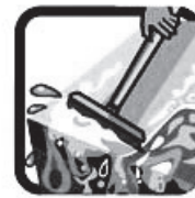
NÃO DEIXE ÁGUA ACUMULADA SOBRE A LAJE
