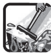
NÃO DEIXE ÁGUA ACUMULADA SOBRE A LAJE
