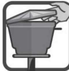
• Mantenha a caixa d'água sempre fechada com tampa adequada.
